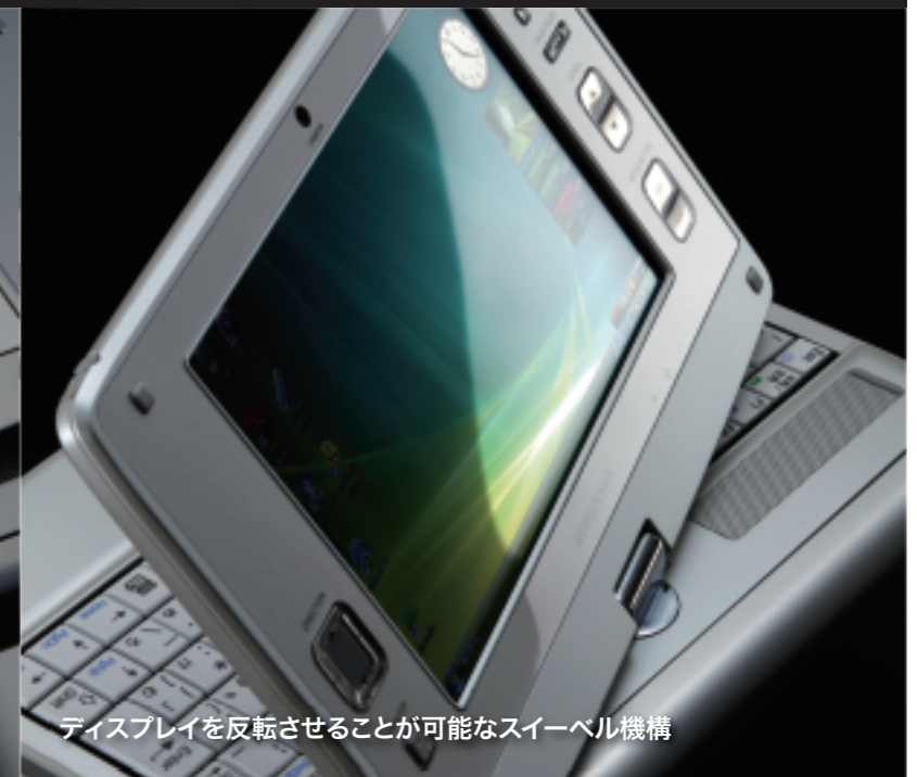
タッチパネル搭載の7型ワイド液晶(1024×600ドット)
