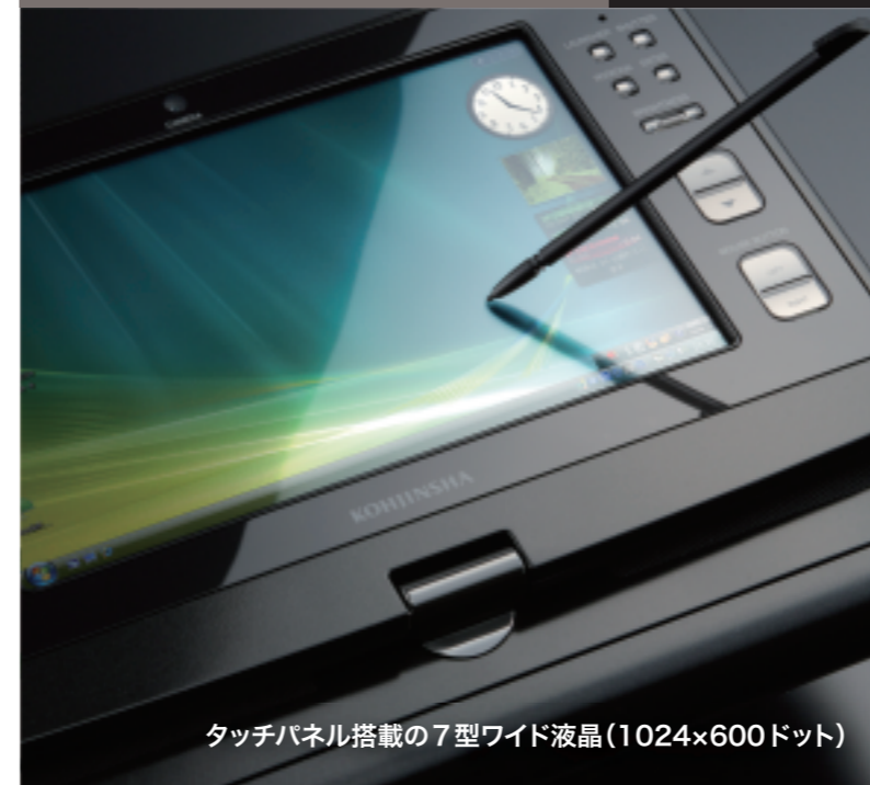
ディスプレイを反転させることが可能なスイーベル機構
